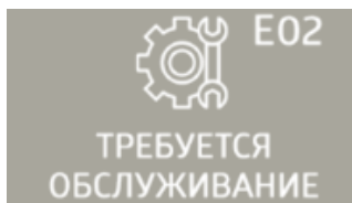
Рисунок 11 – Индикация ошибки E02
